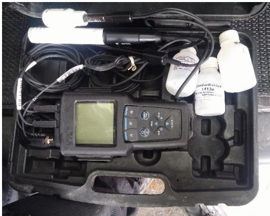
Multiparamétrico (equipo de medición ínsitu)
