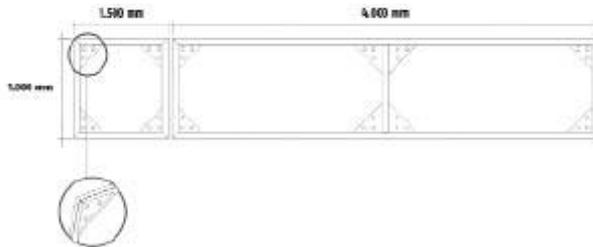
Estructura desmontable: Confeccionado en marco perimetral de caño de Hierro con diseño y medidas según muestra, para carteles identificadores de fachada de talleres de RTO. Esta estructura estará armada con puntos rígidos realizados con soldaduras y soportes de sujeción los cuales tendrán perforaciones para tornillos.
